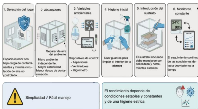
Figura 3. Principios básicos para el diseño de una cámara de cultivo de hongos comestibles. Esta figura incorpora elementos gráficos parcialmente creados con FigureLab, bajo el plan gratuito y Power Point.
