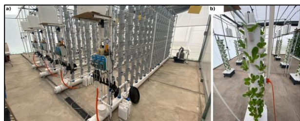
Figura 1. Sistemas verticales de HORTIVERT-UASLP: a) GrowPipes® y unidad de fertirriego; b) torre TIRUSS® con hortalizas de hoja. Fuente: archivo HORTIVERT-UASLP.
