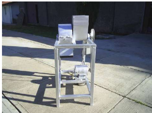
Figura 1. Sistema de trillado de cápsulas de achiote seco.
